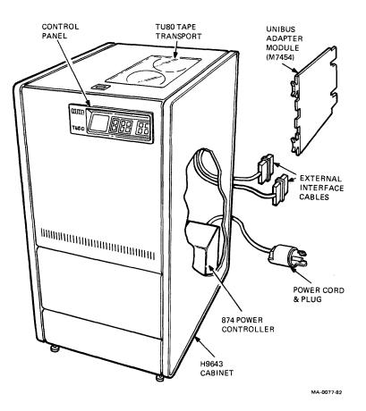
Figure 1-1 TU80 Tape Subsystem
