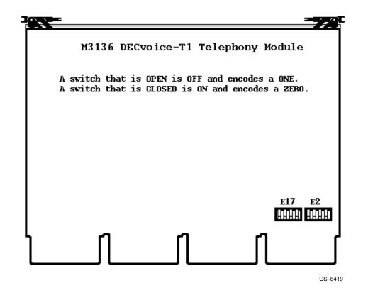
Figure 4 M3136 Module Switchpacks
