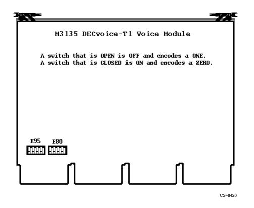
Figure 6 M3135 Module Switchpacks
